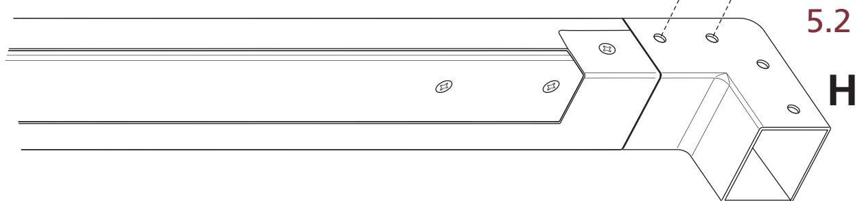
**6** Inserire sui fissi F-DX e F-SX l'assemblaggio dei profili orizzontali superiori (6.1).
